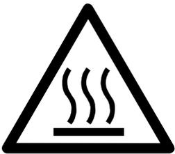
**ATTENZIONE - CALDO:** Alcuni elementi della griglia, come la protezione e la piastra, si riscaldano a temperature molto elevate. Non toccarli mai quando l'apparecchio è riscaldato per evitare ustioni.
