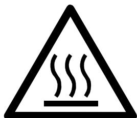
**UWAGA GORĄCE:** Powierzchnia płyty indukcyjnej nagrzewa się do bardzo wysokich temperatur. Nigdy nie dotykaj jej, gdy płyta jest rozgrzana, aby uniknąć ryzyka poparzenia.
