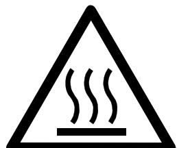
**PRECAUCIÓN - CALIENTE:** La superficie del aparato se calienta a temperaturas muy altas. Nunca lo toque cuando el aparato esté caliente para evitar quemaduras.
